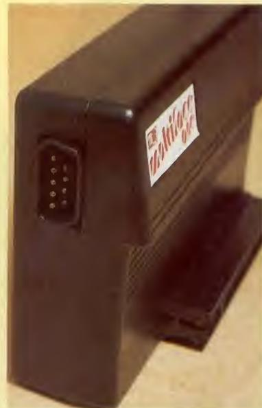
Detalle de la conexión para joystick Kempston.
